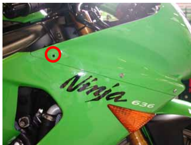
Figura 2: .Vite laterale da rimuovere.
