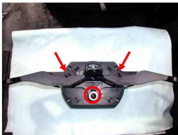
Figura 6: viti che fissano il cruscotto di serie.
