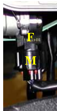
Figura 16: il connettore TPS di serie
