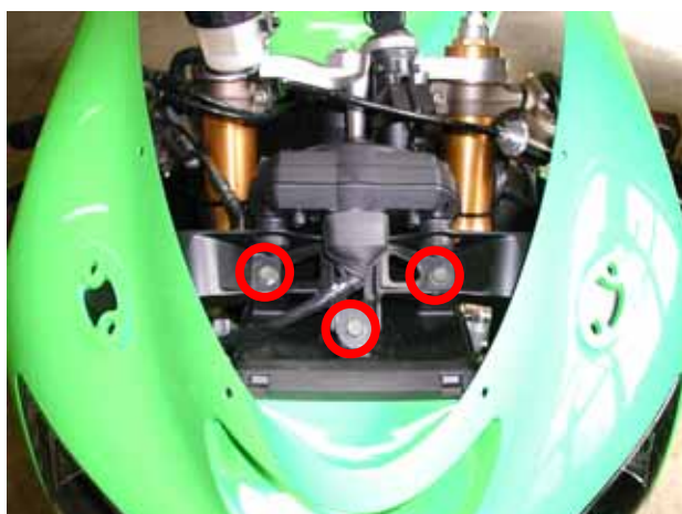
Figura 4: Posizione delle viti del telaio interno.
