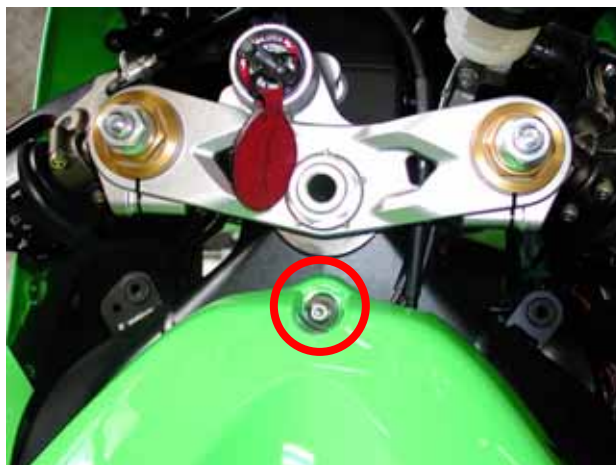
Figura 14: posizione della vite del serbatoio
