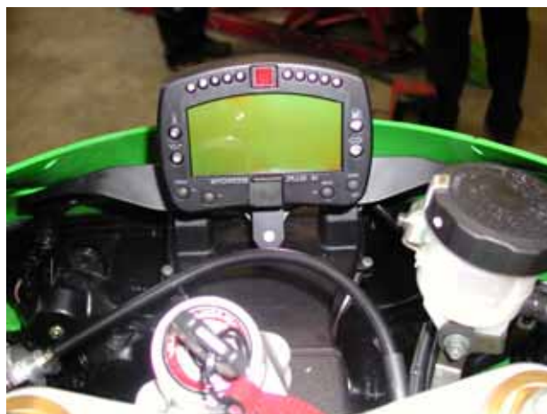
Figura 10: MyChron 3 Plus correttamente installato.
