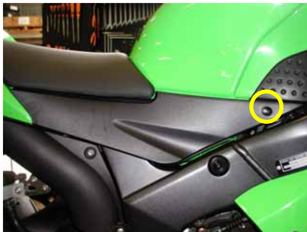
Figura 12: posizione vite del telaietto di plastica.
