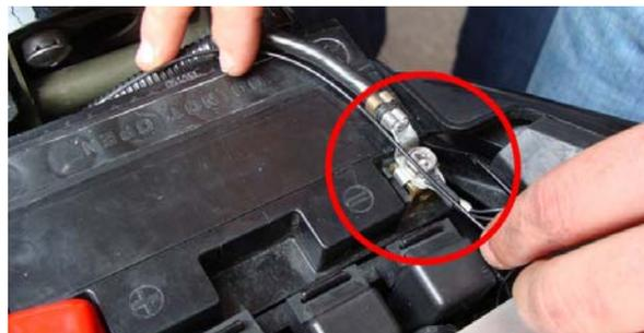
**Figura 11 :** collegamento del cavo di massa al polo negativo della batteria.
