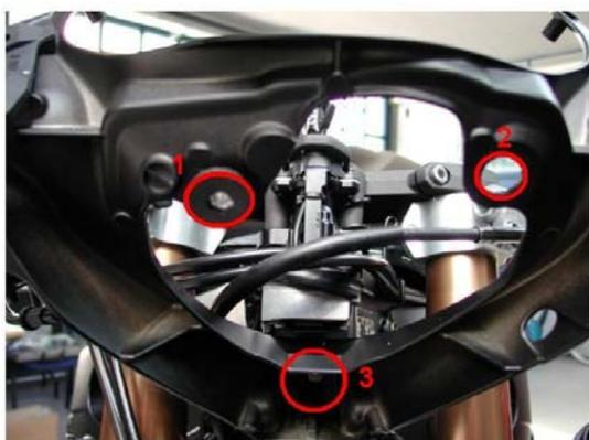
**Figura 1a:** punti di fissaggio del cruscotto di serie vista posteriore.
