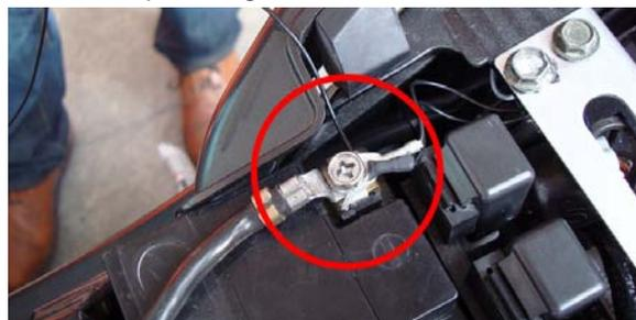
**Figura 12:** Cavo correttamente collegato.
