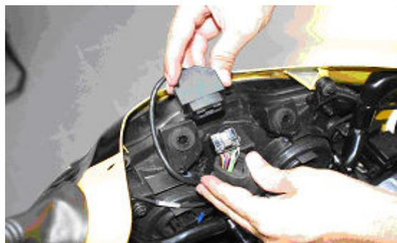
**Figura 24:** Installazione cavi – particolare connettore AMP.
