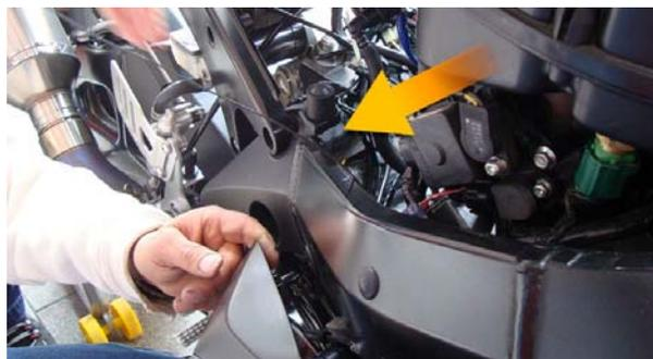
**Figura 10:** il cavo di massa scorre lungo il telaio.
