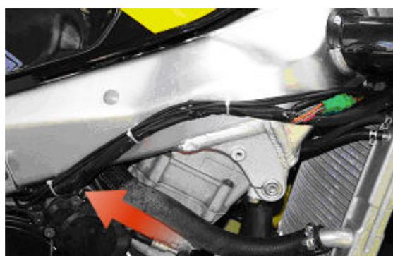
**Figura 25:** i cablaggi scorrono lungo il telaio.
