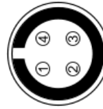
Pinout connettore Binder 719 - 4 pin femmina vista lato terminazioni di saldatura
