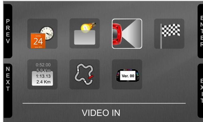
Impostare la telecamera come spiegato nel paragrafo 4.3. Se non viene premuto alcun tasto entro 5 secondi, il menu sparisce ed il dash mostra l'immagine della telecamera in diretta, il che è molto utile per controllarne la posizione. Le immagini sotto mostrano l'immagine della telecamera impostata a sinistra e l'immagine in tempo reale a destra.
