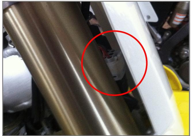
Il collegamento deve essere effettuato come spiegato nel paragrafo precedente. Una volta terminata questa operazione il cavo AiM collegato dietro la targa porta numero tra le forcelle deve passare sopra la piastra della moto. Le immagini sotto mostrano il percorso del cavo.
