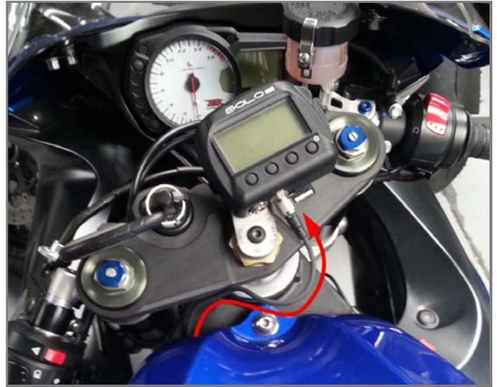
Per collegare SoloDL al Binder maschio del cavo **V02569140** utilizzate il connettore Binder femmina posto sotto a destra dello strumento come mostrato sotto.
