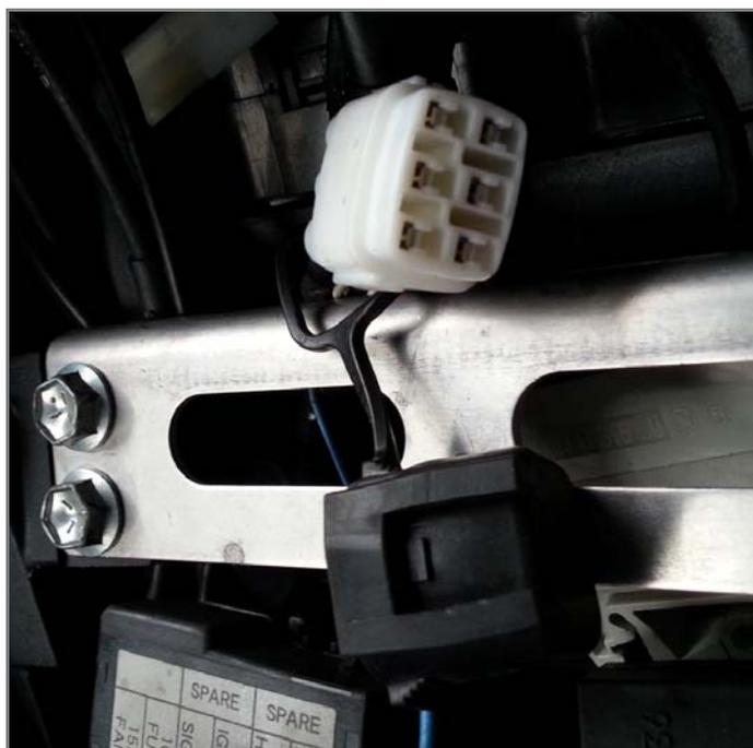
Collegare il cablaggio AiM al cablaggio Suzuki come evidenziato a destra.
