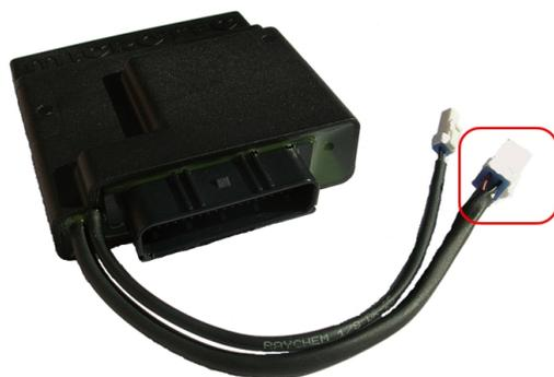
**Nota:** la centralina Microtec alimenta anche SoloDL. Non è quindi necessario controllare lo status della batteria interna.
