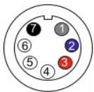
Pinout connettore Binder 712 - 7 pin maschio vista lato terminazioni di saldatura
