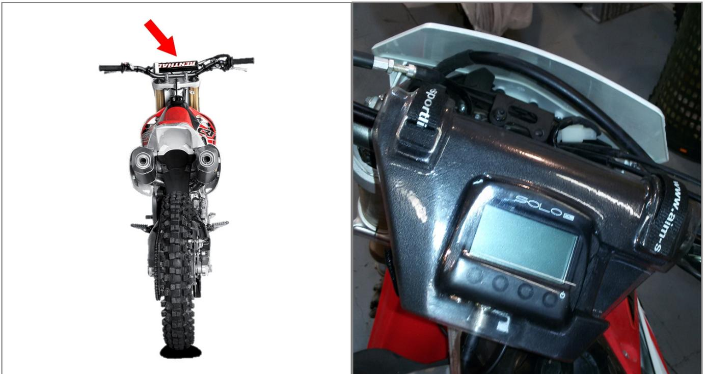
Honda CRF con il setting tool PGM-Fi comunica con Honda Diagnostic System (HDS) attraverso la Linea K sul connettore Sumitomo rosso (DLC) posto sul lato sinistro della moto. Esso collega anche la pompa del carburante. Le immagini sotto mostrano la posizione del connettore Sumitomo a sinistra ed il connettore in dettaglio a destra.
