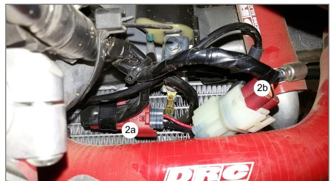
Lo schema sotto mostra il collegamento di SoloDL, del cavo AiM e del cablaggio Honda: collegate il cavo AiM (1) ai connettore Honda etichettati **2a** e **2b**.
