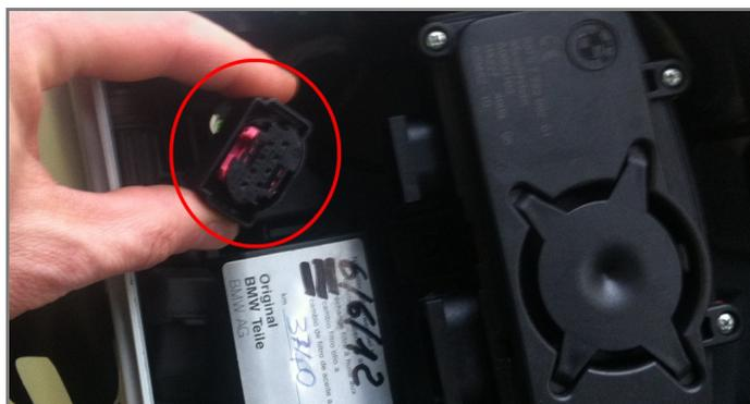
Collegare il cablaggio AiM al cablaggio BMW come evidenziato a destra.
