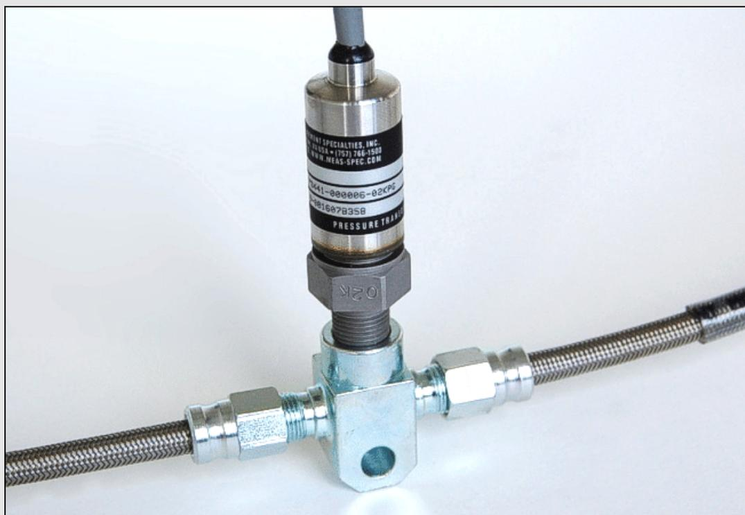
**Attenzione:** quando l'installazione del sensore è terminata assicuratevi che il circuito frenante sia correttamente spurgato ed effettuate un collaudo dell'impianto per verificarne la tenuta.
