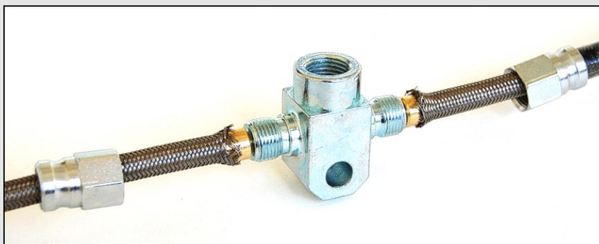
Avvitate alternativamente i due filetti di un quarto di giro fino a raggiungere la posizione esatta e **fate attenzione a non superare i 1,5 Kg (15 Nm)**.
