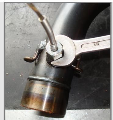
**Attenzione:** nel far correre il cavo della termocoppia lungo il telaio tenetelo il più lontano possibile da altri cavi (come il cavo RPM o quello del ricevitore di giro) per minimizzarne le eventuali interferenze.
